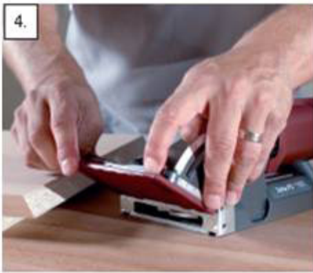
4. Ajustar el tope frontal abatible a 60° y colocar la placa auxiliar de 4 mm
