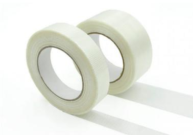
Cinta adhesiva de polipropileno biorientado (BOPP) transparente, con adhesivo caucho sintético y refuerzo de fibra de vidrio. Disponible con refuerzo mono-axial (R-10) y bi-axial (R-20).
