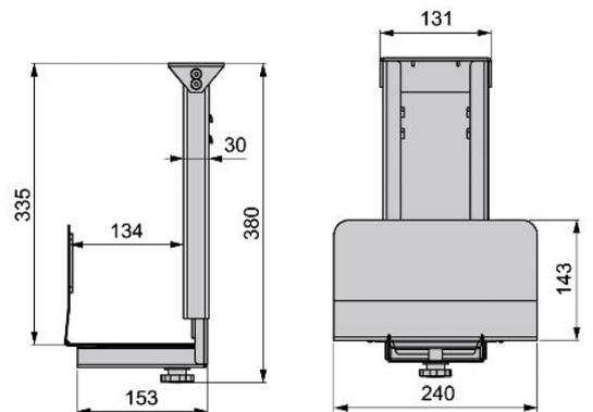
Se monta en la parte inferior del sobre de la mesa mediante tornillos /
