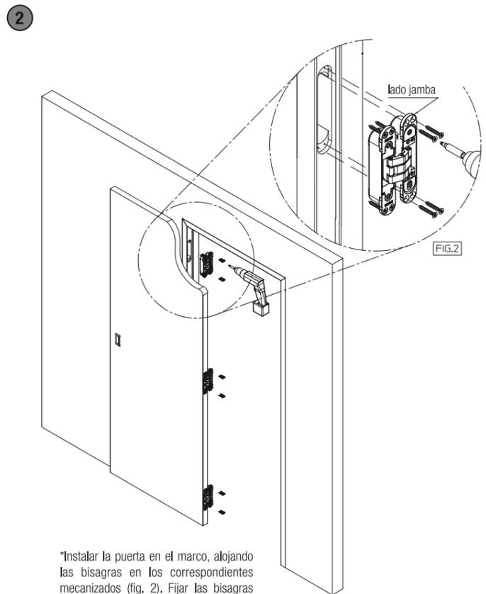
\*Instalar la puerta en el marco, alojando las bisagras en los correspondientes mecanizados (fig. 2). Fijar las bisagras con los tornillos.
