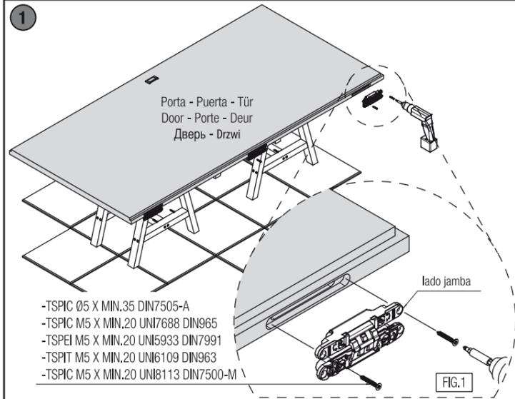
\*Alojar las bisagras en los mecanizados de la puerta (fig.1) y fijarlas con los tornillos suministrados.
