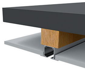
Montaje 1 con falso techo
