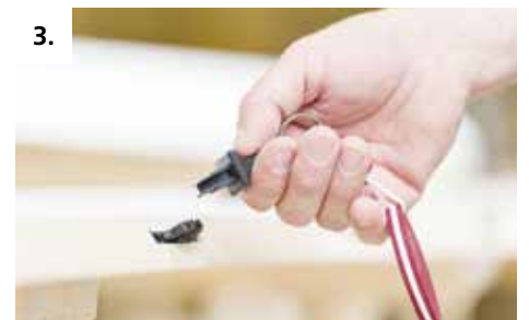
3. Colocar el clip de pre carga en la herramienta de inserción
