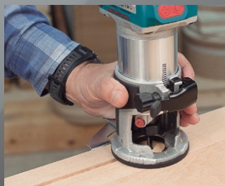
Realización de regatas.
