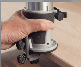
Realización de chaflanes o molduras.
