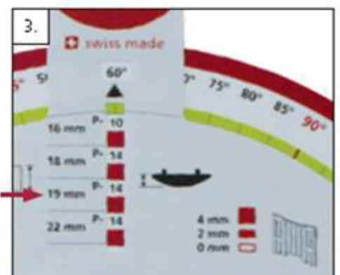
3. Para el espesor de 19 mm se necesita conector P 14 y la placa auxiliar de 4 mm
