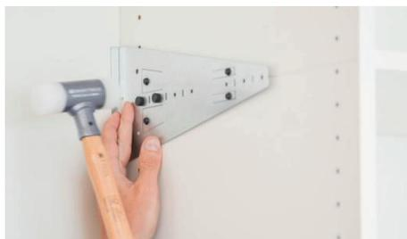
Coloque la plantilla de marcado en el borde posterior del panel y marque los centros de perforación
