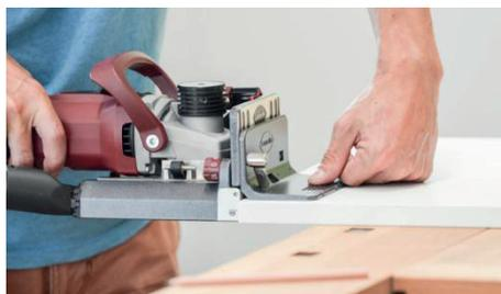
Haga ranuras longitudinales y mecanice con el sistema P en el estante
