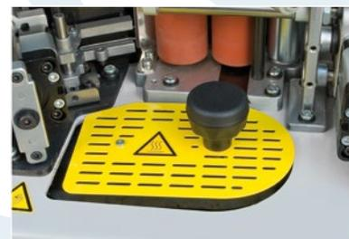
Depósito de cola con tratamiento de polimerización antiadherente. Reducción importante del consumo de cola.
