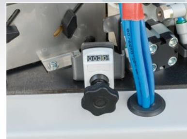
Regulación simultánea con sólo un contador digital, para el espesor del canto y las posiciones de la guía de entrada y del rodillo aplicador de cola.
