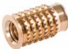
Casquillo Cabineo M6 x 15.3 Para materiales 17-25 mm
