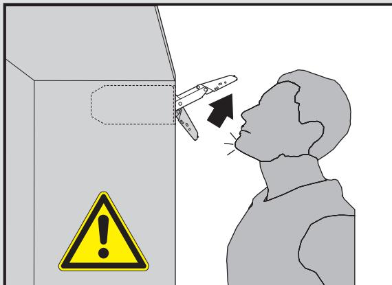
Verletzungsgefahr durch hochspringenden Hebel!
