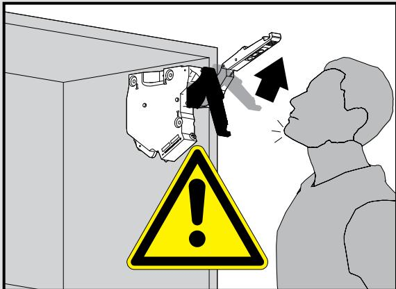
Verletzungsgefahr durch hochspringenden Hebel!
