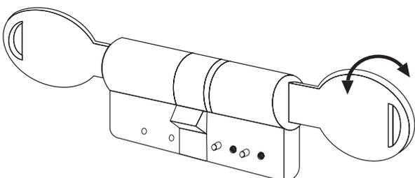
Cilindro con función de emergencia y peligro "doble embrague": la llave se puede girar y usar desde afuera, incluso si hay una llave insertada en el interior.
