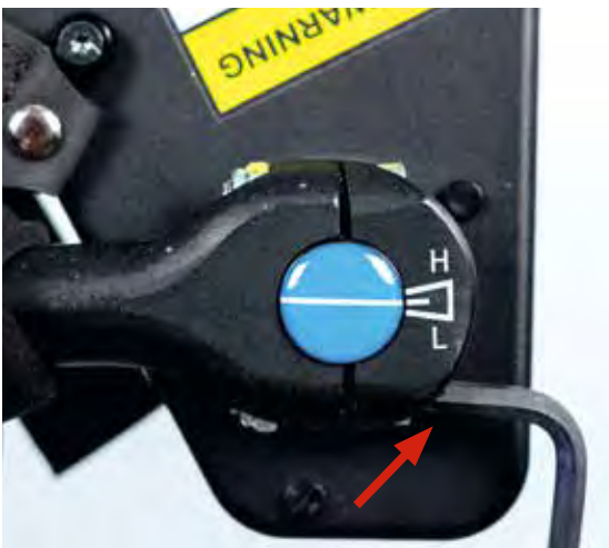
Abbildung 19: Lösen der Schraube
