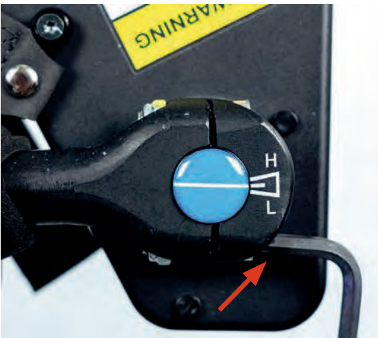
Imagen 19: Aflojar el tornillo del conmutador
