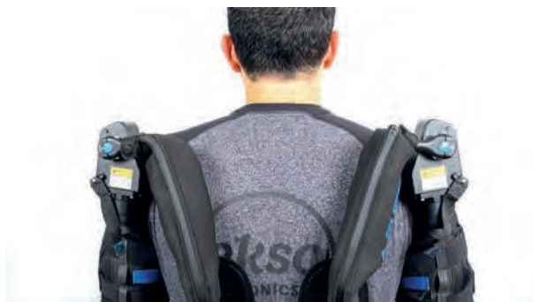
Imagen 10: Alineación adecuada de la altura del actuador del Ekso EVO
