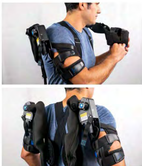
Figure 14 : Installation des suspensions Ekso EVO
