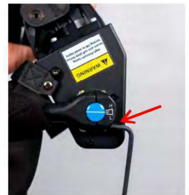
Figure 20 : Relâchement Vis de biellette d'extrémité
