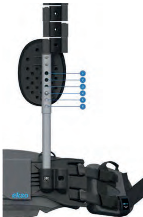
Imagen 8: Posiciones del tubo en la parte superior del torso
