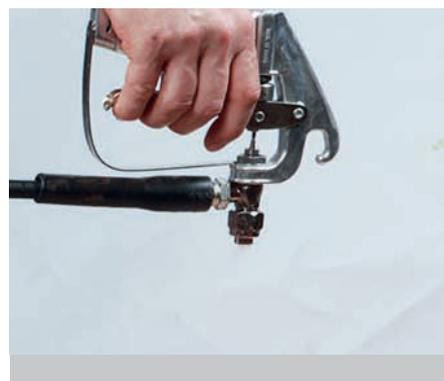
En cuanto usted pueda pulverizar solvente suficiente, la manguera estará limpia. Dejar actuar el solvente 24h si la manguera está totalmente atascada.
