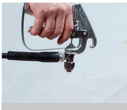
Pulverizar hasta obtener un bonito chorro uniforme.
