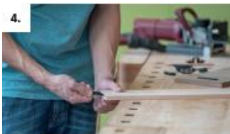
4. Insertar en el costado del cajón la mitad del conector con clips
