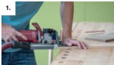
1. Fresamos el costado del cajon con una profundidad de 18 mm
