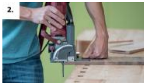
2. Fresamos el frente del cajón con profundidad 10 mm
