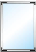
Escuadras de fijación para el ensamblaje del marco de las puertas y la fijación de la bisagra.
